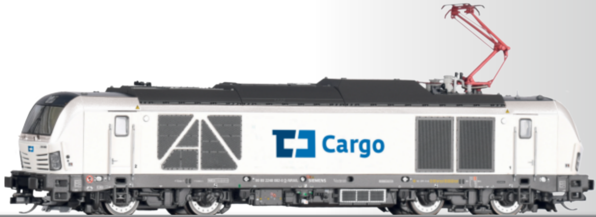
Zweikraftlokomotive 248 082 der ČD Cargo Dual Power locomotive 248 082 of the ČD Cargo
