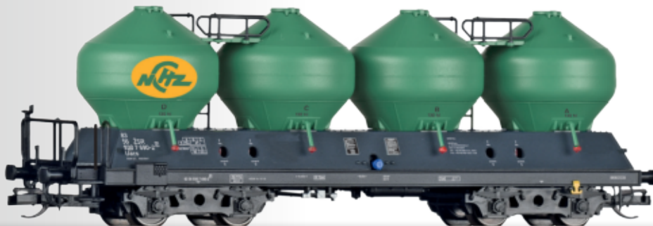
Staubsilowagen Uacs der Novácké chemické závody a.s. Silo car Uacs of the Novácké chemické závody a.s.
