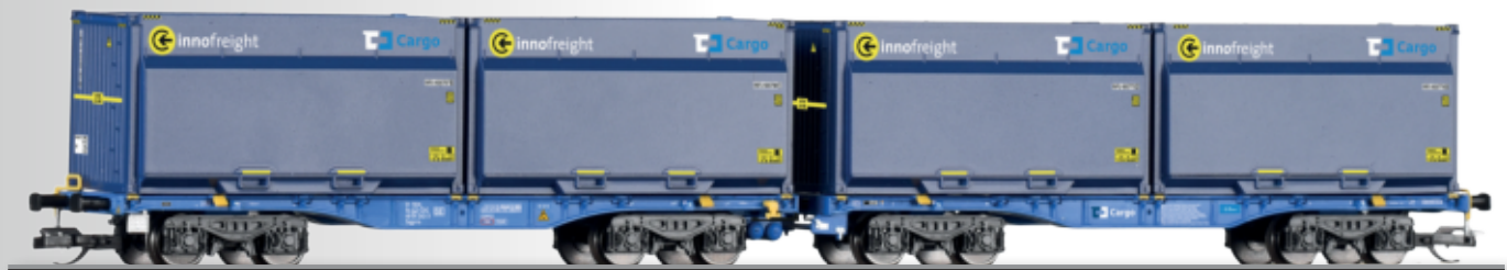
Doppeltragwagen InnoWaggon der ČD Cargo, beladen mit vier WoodTainer XXL Container car InnoWaggon of the ČD Cargo load with four WoodTainer XXL
