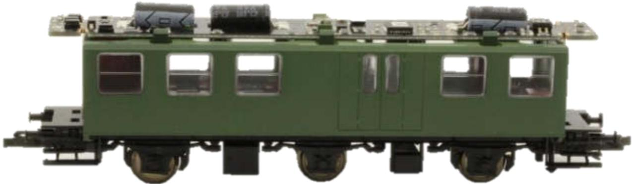
Setzen Sie die Beleuchtungsmodul in der richtigen Position, wie angegeben, auf das Oberteil.
