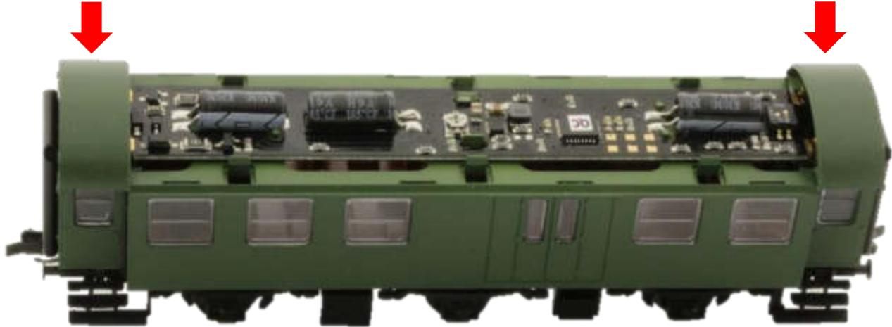
Setzen Sie das Einstieg Gehäuse auf den Wagenkasten.
