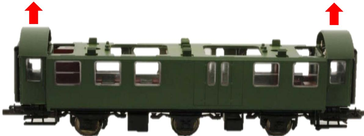
Ziehen Sie den Einstieg Gehäuse des Wagens, wie durch die Pfeile angedeutet nach oben, und entfernen Sie das Einstieg Gehäuse vom Oberteil.
