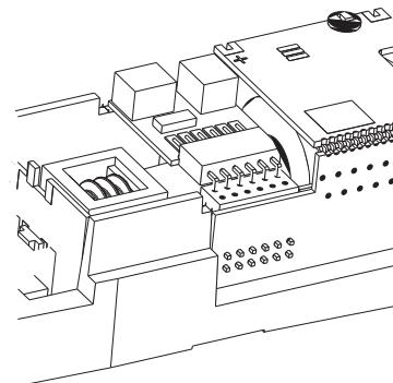
**(DE)** Für eine Digitalisierung gibt es im Modell eine PluX12-Schnittstelle. Wir empfehlen die Verwendung eines Decoders PluX12 von Uhlenbrock (TILLIG Art.-Nr. 66035). Zum Einbau des Decoders ist das Oberteil entsprechend der Anleitung auf Seite 1 abzunehmen. Seitlich in der Rahmeneussparung befindet sich die Decoderschnittstelle.
