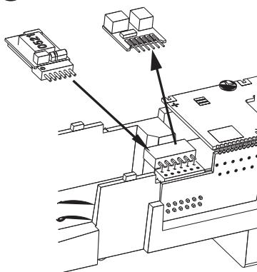
**(DE)** Zum Einbau eines Decoders nach NEM 651 S klein wird nur der Entstörsatz abgezogen. Danach kann ein Decoder nach NEM 651 S klein eingelegt werden. Hierfür empfehlen wir den Decoder von Uhlenbrock (TILLIG Art.-Nr. 66032).
