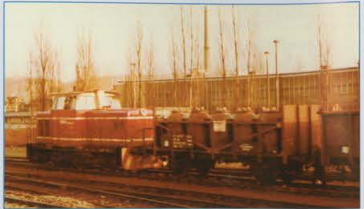
Schnappschuß auf dem Bahnhof Rudolstadt: T 334 als Werklok des Chemiefaserkombinates "Schwarza" mit Säuretopfwagen
