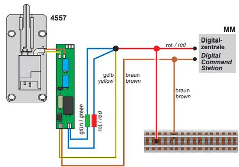
Anschluss nach Adressprogrammierung für invertierte Stellrichtung!
