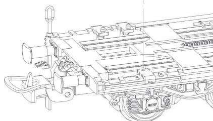
**(DE)** Containerbrücke (wird bei Beladung anstelle der Containeraufnahmepfosten eingesetzt)
