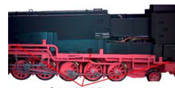
Wasserkästen abnehmen (dazu sind die drei Rastungen auf jeder Seite zu lösen)
