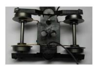
6. Die Litze durch die längliche Aussparung in das Wageninnere führen. Drehgestelle montieren.
