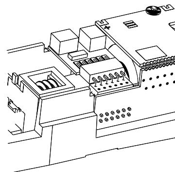
**(DE)** Für eine Digitalisierung gibt es im Modell eine PluX12-Schnittstelle. Wir empfehlen die Verwendung eines Decoders PluX12 von Uhlenbrock (TILLIG Art.-Nr. 66035). Zum Einbau des Decoders ist das Oberteil entsprechend der Anleitung auf Seite 1 abzunehmen. Seitlich in der Rahmeneussparung befindet sich die Decoderschnittstelle.
