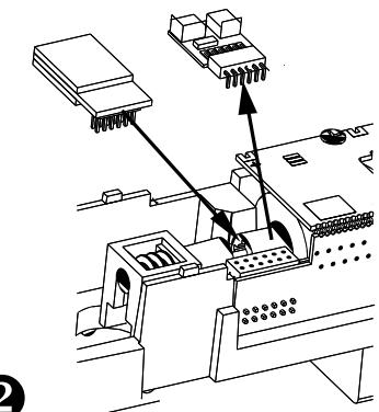
**(DE)** Zum Einbau eines PluX12-Decoders nach NEM 658 wird der Entstörsatz mit dem Adapterleiterplatte abgezogen. Danach kann ein PluX12-Decoder eingesetzt werden.
